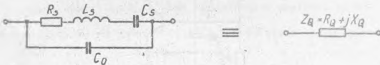
Rys. 9. Schemat zastępczy rezonatora kwarcowego
