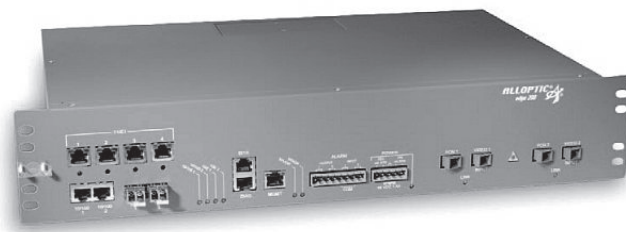
Rys. 10. Zakończenie linii światłowodowej dla sieci GE-PON (Alloptic Edge200) [23]
