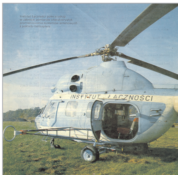
Rys. 2. Wielozadaniowe laboratorium kontrolno-pomiarowe na śmigłowcu
