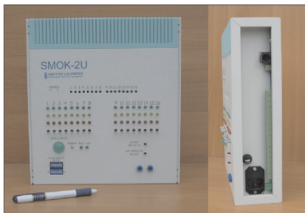
Rys. 2. Głowica pomiarowa systemu SMOK-2U w wersji analogowej
