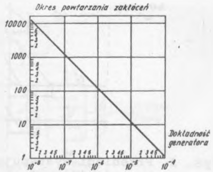
Rys. 5. Zależność okresu powtarzania zakłóceń ramki PCM od dokładności zastosowanych w sieci asynchronicznej generatorów taktu
