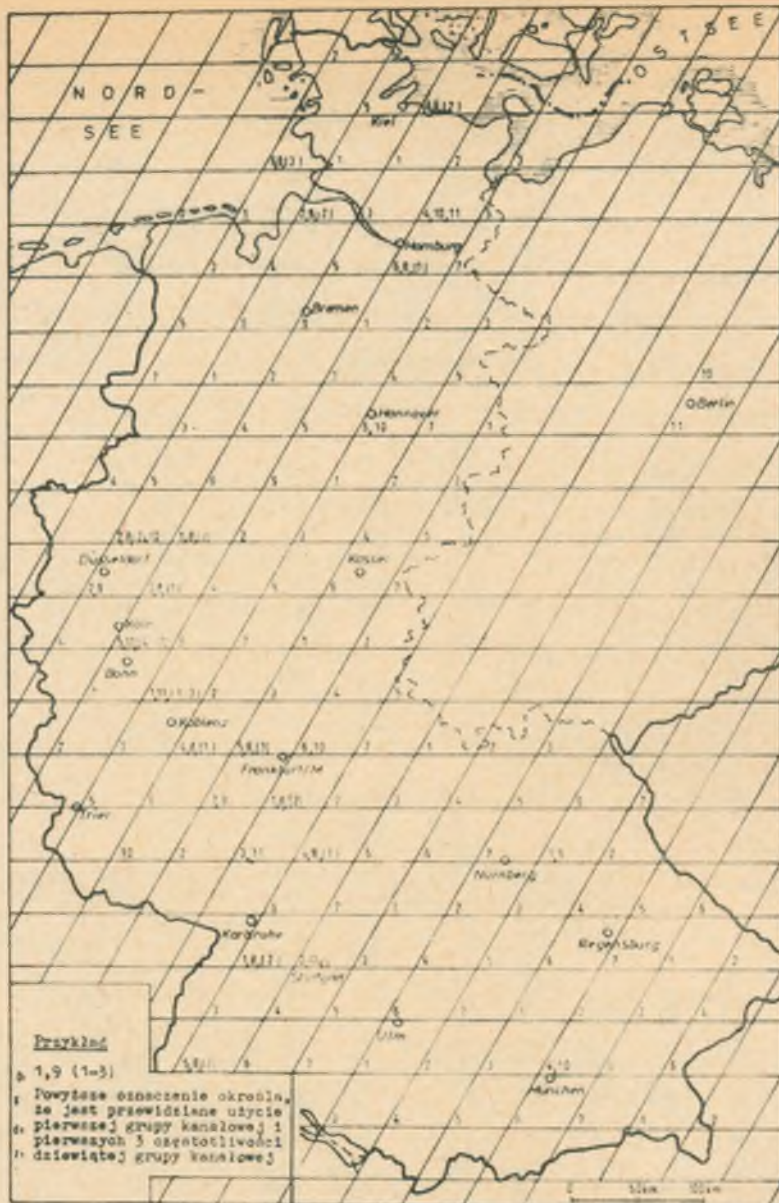
Rys. 1. Tymczasowy plan rozdziału częstotliwości ruchomej lądowej sieci publicznej B planowanej w zakresie 140 MHz
