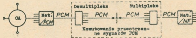
Rys. 3b. Komutacja przestrzenna sygnałów PCM
