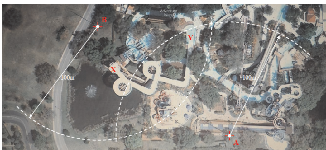
Rys. 10. Śmiertelny wypadek na drodze X-Y (trasa ześlizgu wodnego) zdarzył się między „zwodami ESE” A-B, których deklarowany zasięg ochrony oznaczono strzałkami
