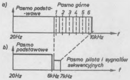
Rys. 41. Sposób tworzenia sygnału modulującego w systemie PICOR
