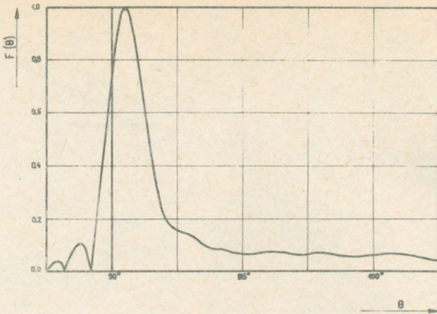
Rys. 33. Pionowa charakterystyka promieniowania anteny szczelinowej o zysku energetycznym 52; apertura anteny - 55 \lambda
