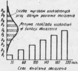
Rys. 2. Krzywa rozkładu uszkodzeń w funkcji narastających obciążeń
