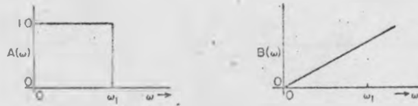
Rys. 16. Charakterystyka amplitudy i fazy idealnego filtra dolnoprzepustowego
