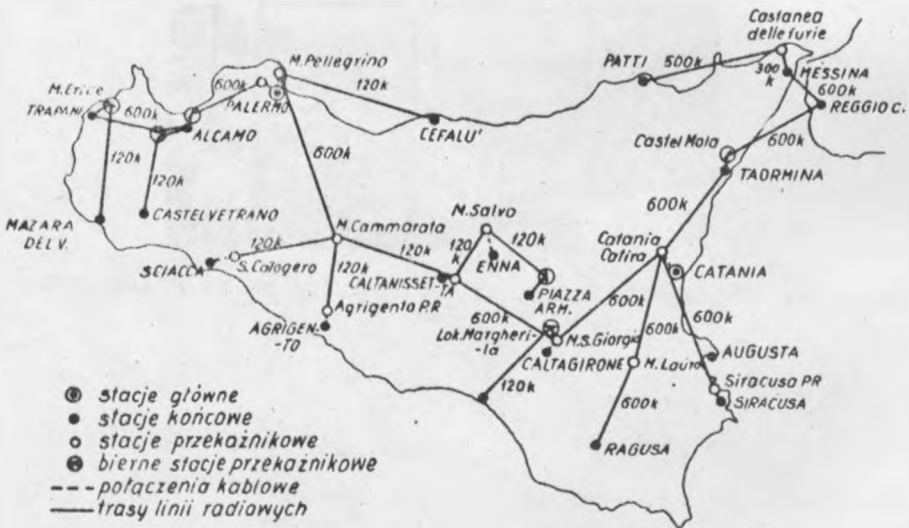
Rys. 29. Sieć sycylijska linii radiowych na zakres 7 GHz
