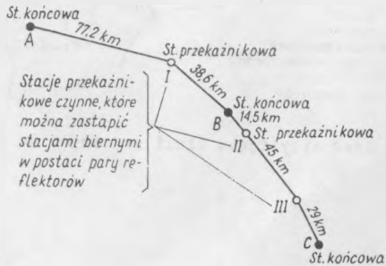
Rys. 27. Wojskowa linia radiowa, w której stacje przekaźnikowe czynne można zastąpić reflektorami biernymi
