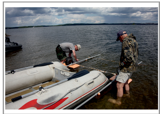
Fig. 22. Testing 4-m dipole antennas.
