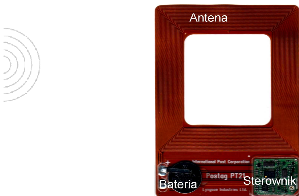
Rys. 2. Znacznik RFID stosowany w badaniach terminowości przesyłek międzynarodowych na terenie Europy
