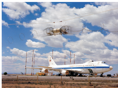
Rys. 16. Stanowisko pomiarowe do badania odporności aparatury elektronicznej zainstalowanej w samolocie na narażenia elektromagnetyczne o dużej energii typu EMP. Generator narażeń jest widoczny nad samolotem. ①
