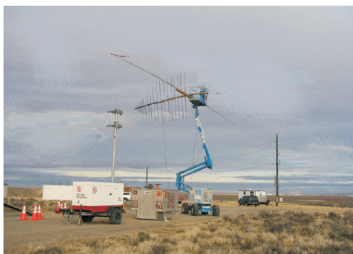
Rys. 15. Stanowisko pomiarowe w terenie do badania odporności kontenerowych stacji bazowych telefonii komórkowej na narażenia elektromagnetyczne o dużej energii [8]
