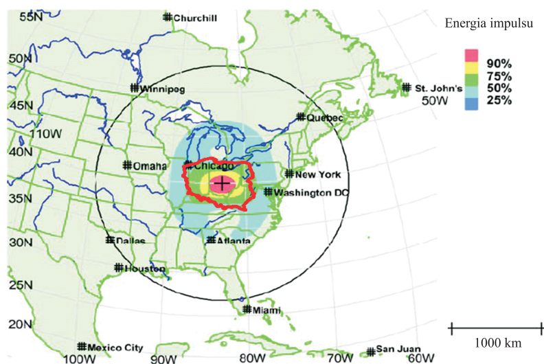
Rys. 9. Wyniki symulacji komputerowej ataku nuklearnym impulsem elektromagnetycznym, wytworzonym w celu zniszczenia krytycznej infrastruktury teleinformatycznej Stanów Zjednoczonych. Okrąg pokazuje zasięg zniszczeń. Dla porównania zamieszczono także mapę konturową Polski w tej samej skali.
