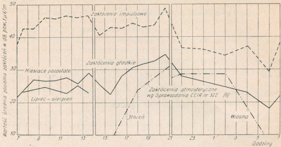
Rys. 1. Dobowa zmienność wartości średniej poziomu przemysłowych zakłóceń radioelektrycznych. Wyniki własne
