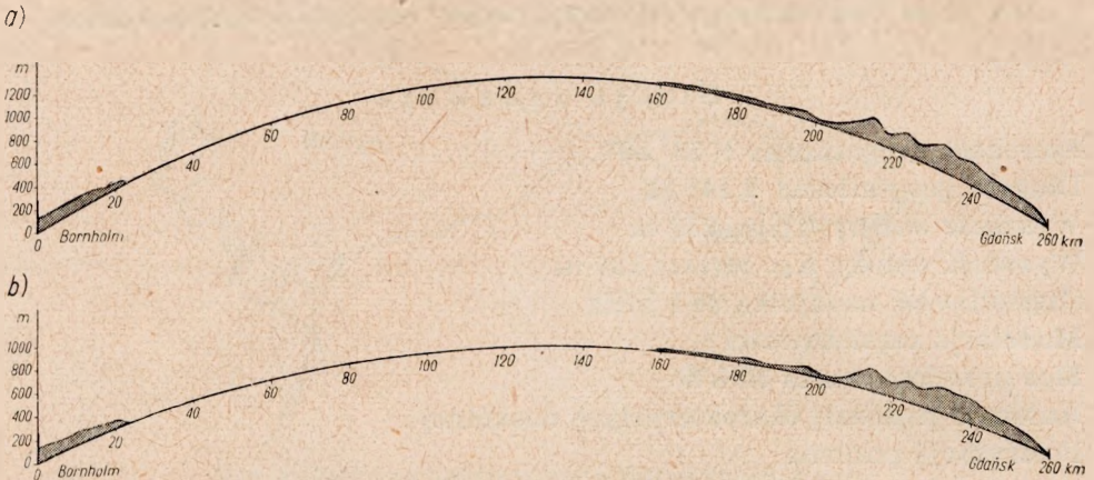
Rys. 2. Profil trasy Bornholm—Gdańsk: a) wykreślony dla rzeczywistego promienia ziemi; b) wykreślony dla atmosfery standardowej ( 4/3 promienia), na współrzędnych pionowych — wysokość wzniesienia w m, na współrzędnych poziomych — odległość w km. W powyższym odwzorowaniu trasy linie proste łączące nadajnik z odbiornikiem pozostają nadal liniami prostymi [3].
