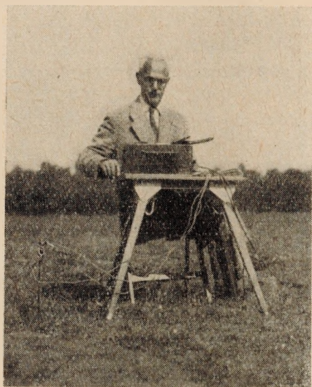
Rys. 12. Pomiar po wbiciu prętów
