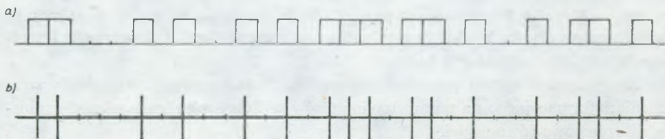
Rys. 3. Zasada zamiany parametrów impulsów w przypadku transmisji bezpośredniej a) ciąg impulsów informacyjnych; b) impulsy b.w.cz.
