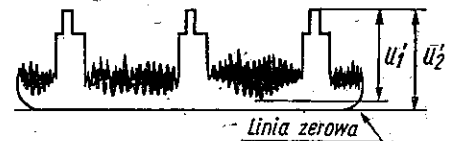
Rys. 2. Sygnał wizyjny po detekcji sygnału w. cz.
