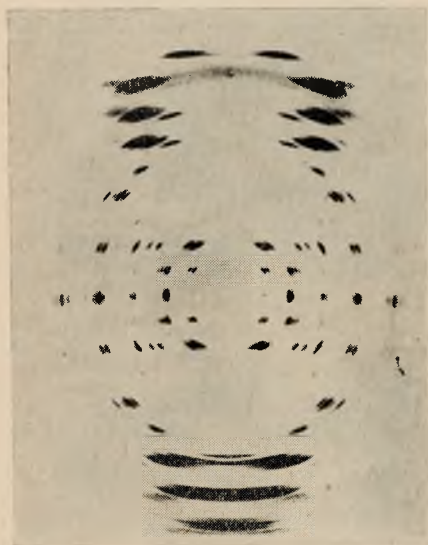
Rys. 7. Obraz dyfrakcyjny cząsteczki KDN w promieniach X (wg Wilkinsa)
