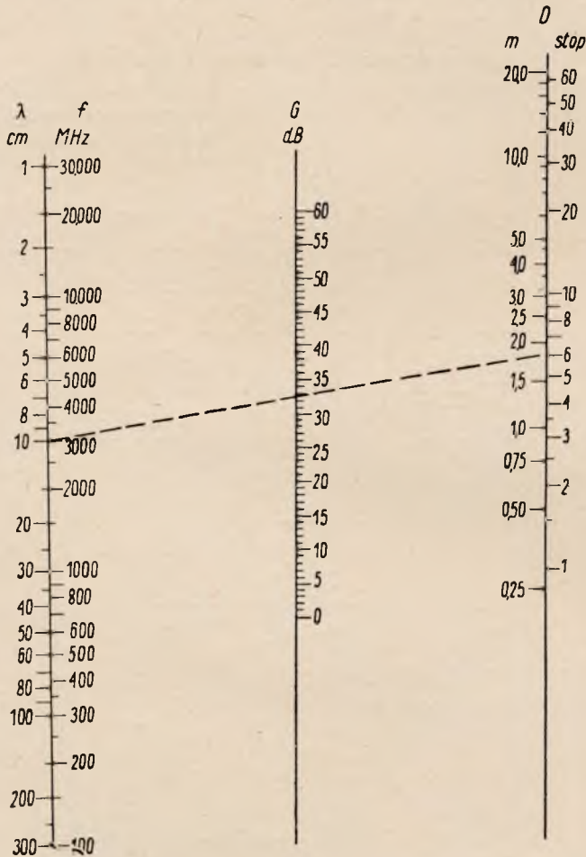
Rys. 22. Nomogram dla obliczania zysków anten \lambda/2 z reflektorami paraboloidalnymi o średnicy D apertury [38]
