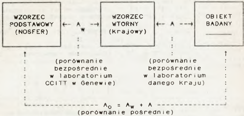
Rys.1. Zasada określania wartości tłumienności odniesienia badanego obiektu na podstawie porównania pośredniego z podstawowym wzorcem telefonometrycznym
