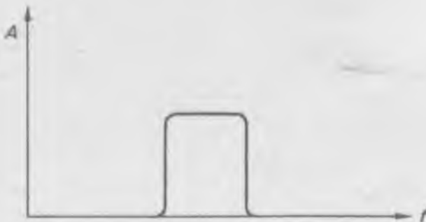
Rys. 12. Charakterystyka tłumieniowa filtra pasmowego
